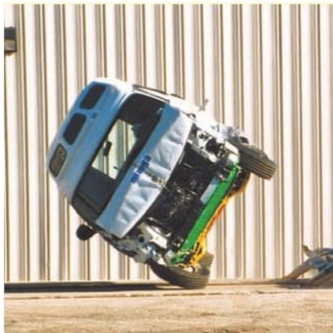
Les essais dynamiques de capotage visent à réduire le nombre de morts et de blessures qui surviennent à la suite de l'éjection des occupants au cours d'un capotage.
