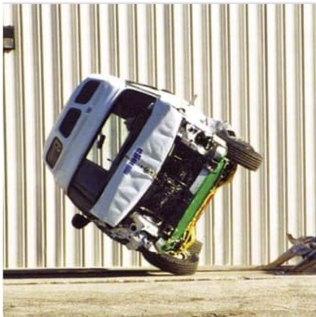
Les essais dynamiques de capotage ont pour objectif de réduire le nombre de blessures et de morts qui surviennent lorsque les occupants sont éjectés au cours d'un capotage.
