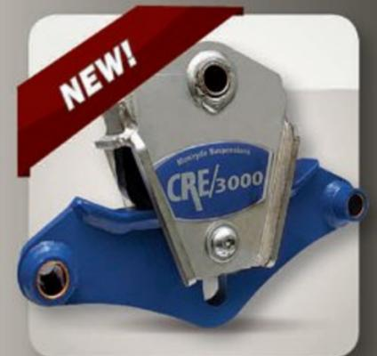
La suspension MOR/ryde CRE 3000 augmente jusqu'à 7,6 cm (3 po) la course dynamique des roues en utilisant du caoutchouc et une fente de course unique pour absorber les chocs. La course accrue signifie un remorquage plus en douceur et une meilleure protection contre les dommages pouvant résulter des chocs de la route.
