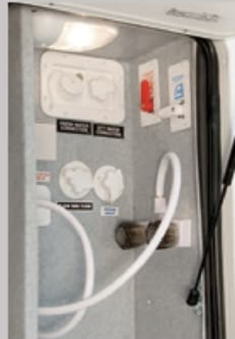
Centre de commodité extérieur incluant une soupape de dérivation du chauffe-eau, une soupape pour faciliter l'hivernisation, douche extérieure avec eau chaude et froide, système de rinçage des eaux noires, prise 110V et connexion pour câble et satellite
