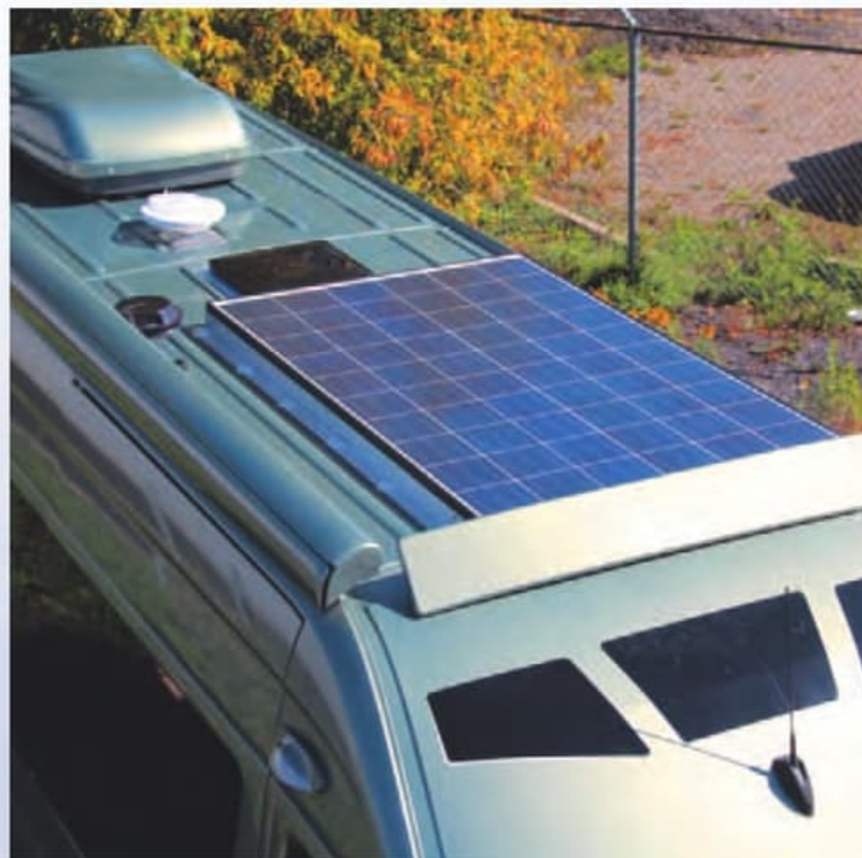
Le système de charge solaire fournit de l'énergie tant qu'il fait clair - pas seulement quand il fait soleil.
