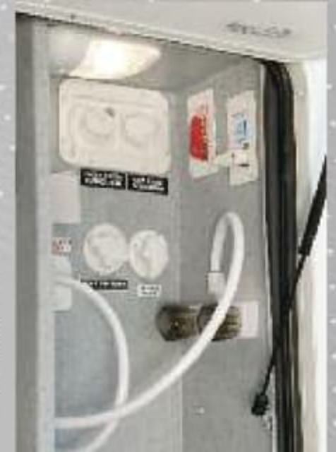
Centre de commodité extérieur incluant une soupape de dérivation du chauffe-eau, une soupape pour faciliter l'hivernisation, douche extérieure avec eau chaude et froide, système de rinçage des eaux noires, prise 110V et connexion pour câble et satellite
