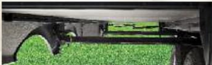
Système d'engrenage à crémaillère sur les rallonges permet au plancher de la rallonge d'être à égalité
