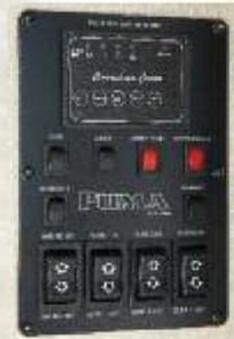
Panneau moniteur mural pour rallonges, lumières, lumières d'entrée, pompe à eau/chauffage; charge de la batterie et détails sur la capacité des réservoirs
