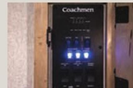
Panneau de contrôle centralisé indiquant les niveaux des réservoirs et de la batterie.
